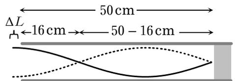
(1) 1 回目と 2 回目に共鳴したときの水位の差が定常波の正確な節と節の間隔である。その間隔が半波長分であるので,求める波長を $\lambda$ とすると, $\frac{\lambda}{2} = 50.0 - 16.0 = 34.0$  よって,
