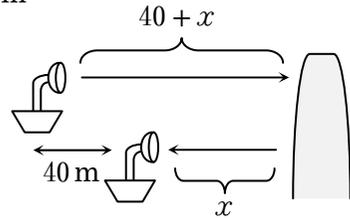
求める距離を  $x$  とする。汽笛を発してから  $4.0 \text{ s}$  後に船は  $10.0 \text{ m/s} \times 4.0 \text{ s} = 40 \text{ m}$  だけ進むので、汽笛の音波が船を出発してから、再び船に到達するまでに、音波の先端が移動する距離は  $40 + 2x$  となる。よって、公式: 距離 = 速さ  $\times$  時間より、 $40 + 2x = 340 \times 4.0$  これを解くと、 $x = 660 \text{ m}$
