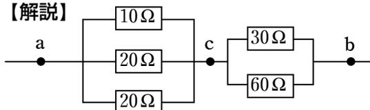
図のように点  $c$  をとり、 $ac$  間の合成抵抗を  $R_{ac}$ 、 $bc$  間の合成抵抗を  $R_{bc}$  とすると、
